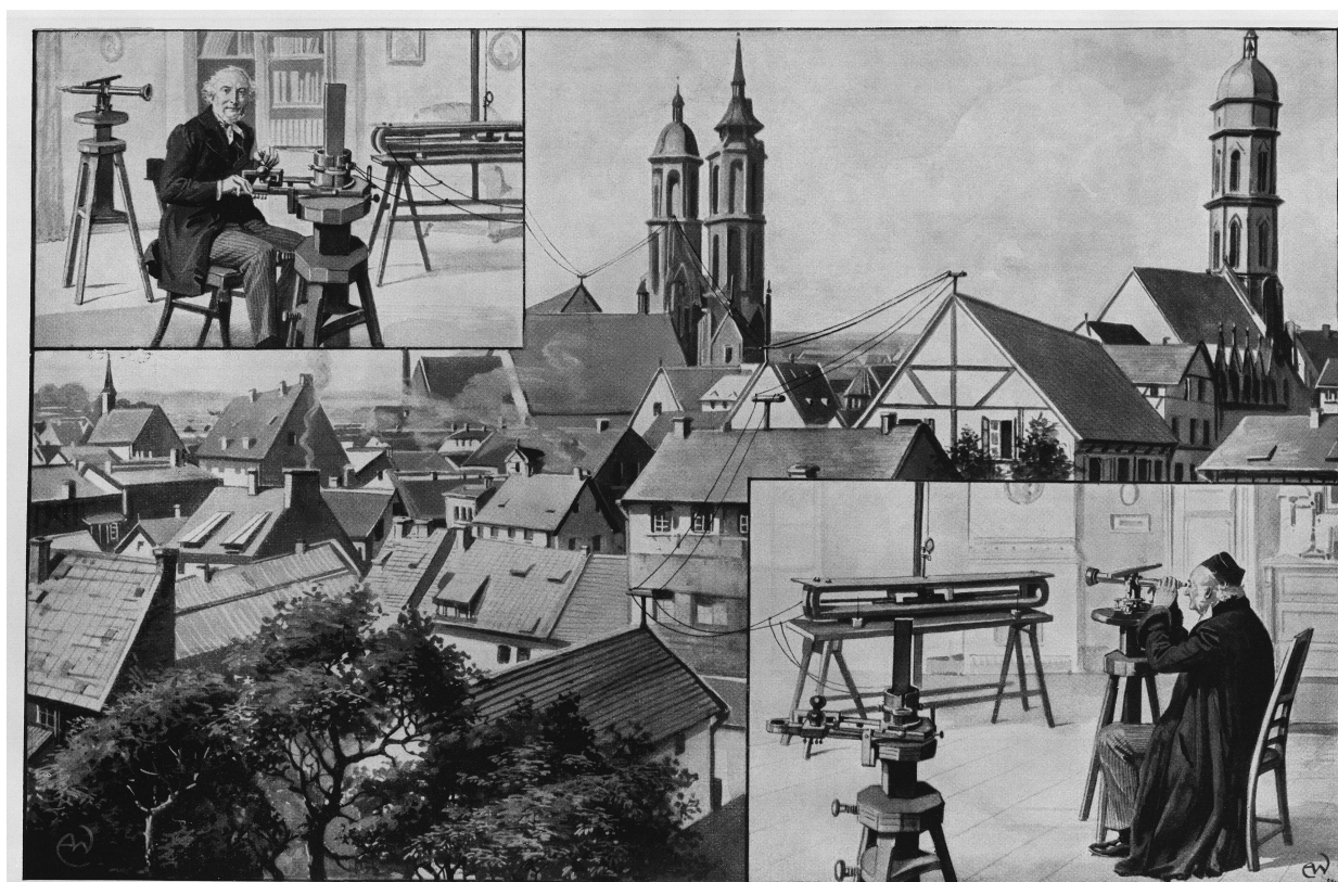
Friedrich Gauß und Wilhelm Weber beim Arbeiten mit dem von ihnen erfundenen ersten elektrischen Nadel-Telegraphen Links Weber am Gebe-Apparat, an dem er die stromverdringende Spule bewegt; rechts Gauß am Empfänger, durch das Fernrohr auf den Spiegel des Galvanometers schauend. In der Multiplikatorspule unter dem Spiegel die Magnethand, ein schwerer Eisenstab. Die Verbindungsdrähte sind über die Stadt Göttingen gespannt und auch am Johannisturm befestigt. Nach einer Zeichnung von A. Wald. (Su Seite 18)
