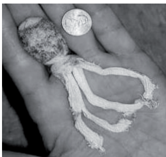
Figur 9.8. 23DS 12. Gauge, "Drag stabilized Bean bag". Projektileten utgörs av hagel inneslutna i en kevlar-påse. Den har en liten anslagsyta och vådaskott kan ge penetration. (Källa: FOI)
