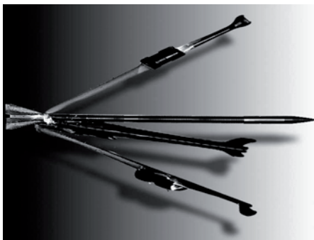
Figur 3.7. Modern pilprojektil strax efter mynningen då drivspeglarna separerar. (Källa: FOI)
